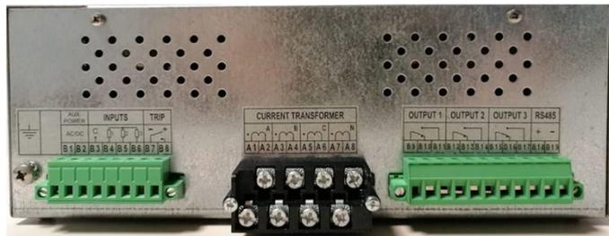
Les autres bornes (Entrées, sorties, communications et alimentation auxiliaire) sont conçues pour un câble 24 AWG - 12 AWG : 0,25 - 2,5 mm<sup>2</sup> avec un couple de 0,5 Nm-0,6 Nm.
